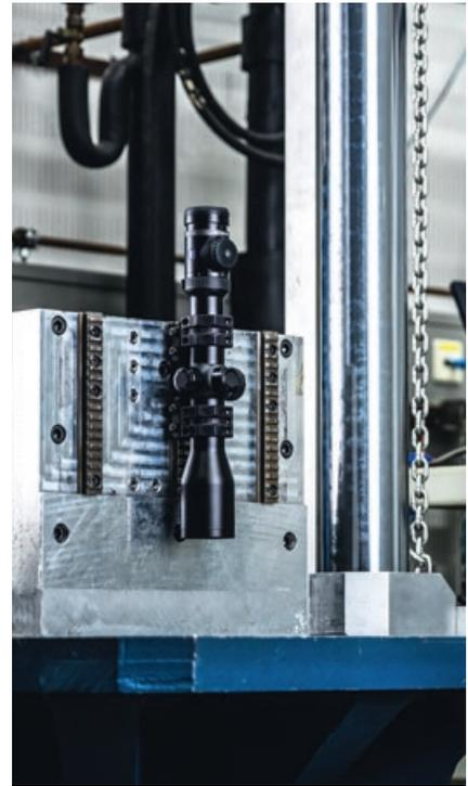
**Extremsituationen im Test:** Hohe Temperaturschwankungen innerhalb von Minuten und Schusssimulationen mit 1.500-facher Erdanziehungskraft.
