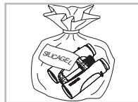
In caso il cannocchiale sia umido, è necessario asciugarlo prima di riporlo. Nelle regioni tropicali o in zone con elevata umidità dell'aria, il migliore luogo dove conservarlo è un contenitore ermetico con un assorbente d'umidità (p. es. silicagel).
