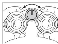
En faisant tourner la molette de focalisation, vous pouvez faire la mise au point sur chaque objet, de la distance minimum de mise au point (voir la fiche signalétique technique) à l'infini.
