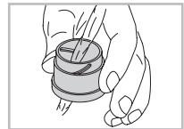
Finns det smuts som är svår att få bort från ögonmusslarna (t.ex. sand), kan man skruva ut dem och putsa dem skilt.
