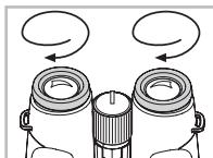
Drehen Sie beide Drehaugenmuscheln (im Uhrzeigersinn) bis zum Anschlag hinein.
