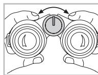
Durch Drehen des Fokussierrades können Sie jedes Objekt von der kürzesten Einstellentfernung (siehe Technisches Datenblatt) bis unendlich scharf stellen. Bei unendlich zeigt die kleine Nase des Fokussierrades nach oben.
