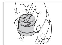
In caso di particolare sporco (p. es. sabbia), le conchiglie oculari girevoli possono essere svitate completamente e pulite con estrema facilità.
