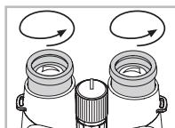
Faites tourner les deux bonnettes oculaires rotatives (dans le sens inverse des aiguilles d'une montre) jusqu'à la butée.
