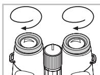
Draai beide draaidoppen (met de wijzers van de klok mee) tot de aanslag erin.
