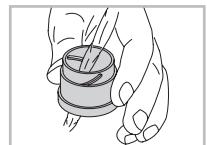
Bij sterke verontreiniging (bijv. zand) kan de oogklep er compleet afgeschroefd en het oculair daardoor eenvoudig gereinigd worden.
