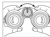
Genom att vrida fokusringen kan du ställa in skärpan på föremål på mycket nära håll (se tekniska data) och upp till oändligt.
