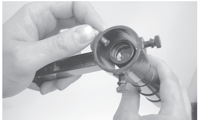
Abbildung 3. Ziehen Sie die federbelastete Spannvorrichtung nach außen, und setzen Sie dann das Sucherfernrohr in die Halterung ein.
