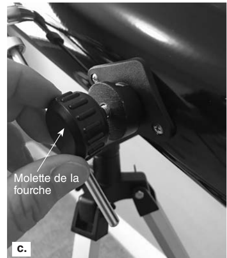
Figure 8. Montage du tube optique sur la monture. a) Faites glisser la tige de micro-mouvement dans le logement métallique. b) Placez les moulages d'altitude situés sur le tube optique dans les rainures de la fourche. c) Installez les molettes de la fourche.
