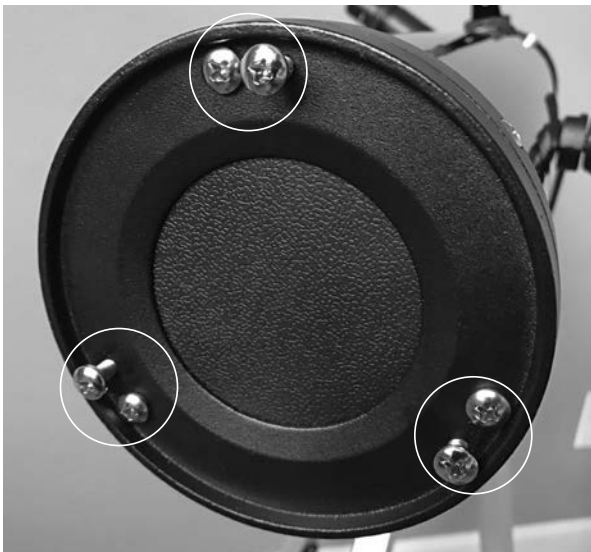
Figure 16. Alignement du miroir primaire par ajustement des trois paires de vis "tirer-pousser" à l'extrémité arrière du tube optique.
