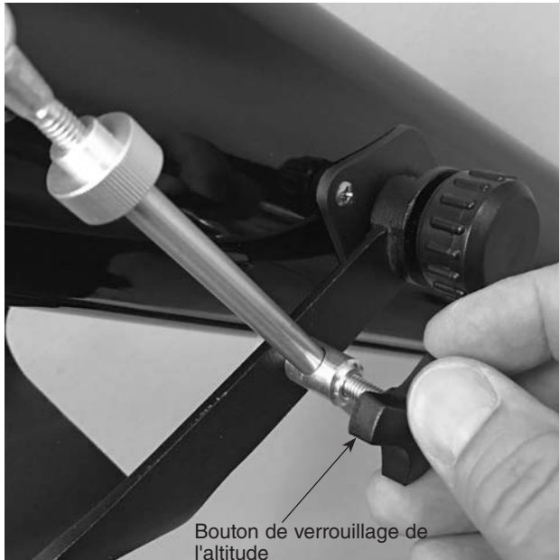
Figure 9. Vissage du bouton de blocage de l'altitude.
