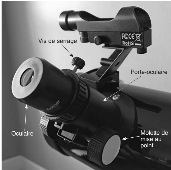
Figure 11. L'oculaire est représenté installé dans le porte-oculaire.
