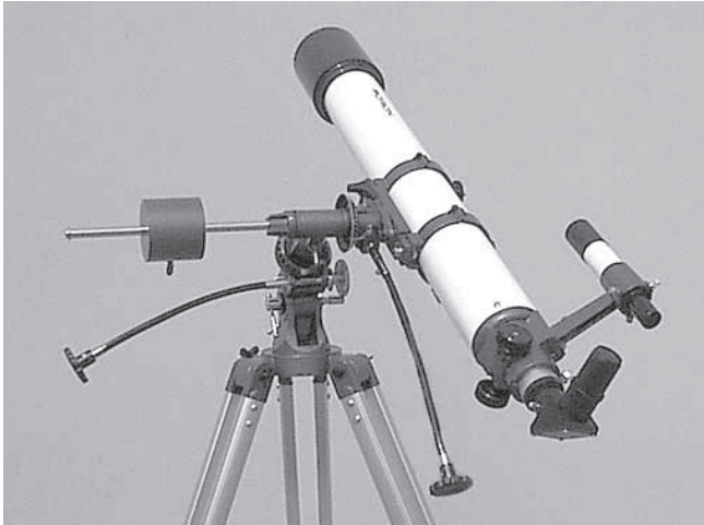
Figura 6a. Telescopio apuntando al sur. Tenga en cuenta que en todos estos ejemplos, la montura y el trípode permanecen estacionarios, solo los ejes de A. R. y Dec. se mueven.
